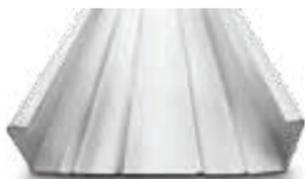
Os guias e montantes Brasilit são produzidos em aço galvanizado de alta qualidade, com 0,95 mm de espessura e revestimento Tipo B (275 g/m<sup>2</sup>). Disponíveis nos tamanhos 90, 140 e 200 mm, em barras de 3 metros, bem como em medidas especiais; eles atendem as principais necessidades de quem escolheu um sistema rápido, prático e sem desperdícios para realizar a sua obra.
