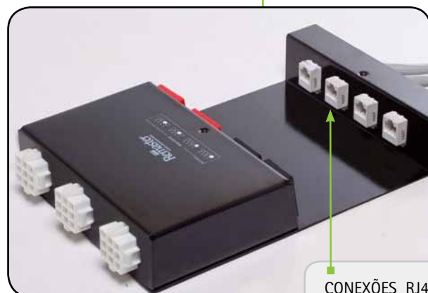
CONEXÕES RJ45 Rede estruturada
